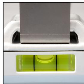
Le couvercle en plastique du côté des composants électroniques est doté d'un niveau à bulle. En faisant pivoter le luminaire autour de l'axe de la lampe jusqu'à ce que la bulle se trouve au milieu, il est possible de mettre le luminaire à l'horizontale (autour de l'axe de la lampe).
