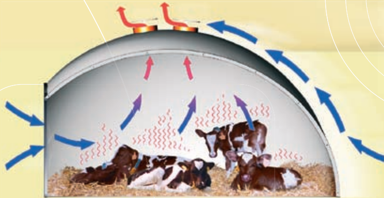
Circulation de l'air à l'intérieur de l'Igloo H&L
